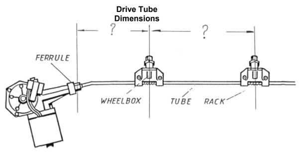
DIAGRAM ABOVE IS LAYOUT FOR LEFT SIDE PARKING. IF CENTRE PARKING OF THE BLADES IS REQUIRED, THEN THE RIGHT HAND WHEEL BOX NEEDS TO BE REVERSE FITTED SO THE DRIVE CABLE WILL RUN ALONG THE TOP OF THE WHEELBOX.
